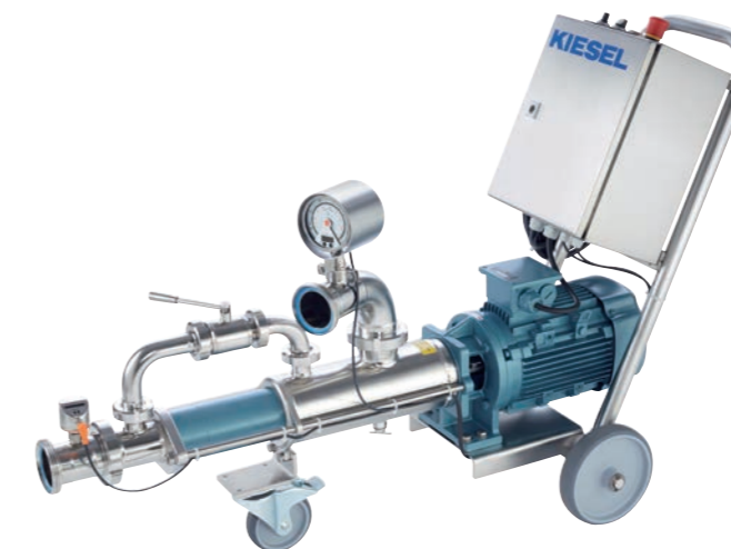
SP 06 M 06 mit abnehmbarem Bypass als Kugelhahn, mit Druck- und Strömungswächter
